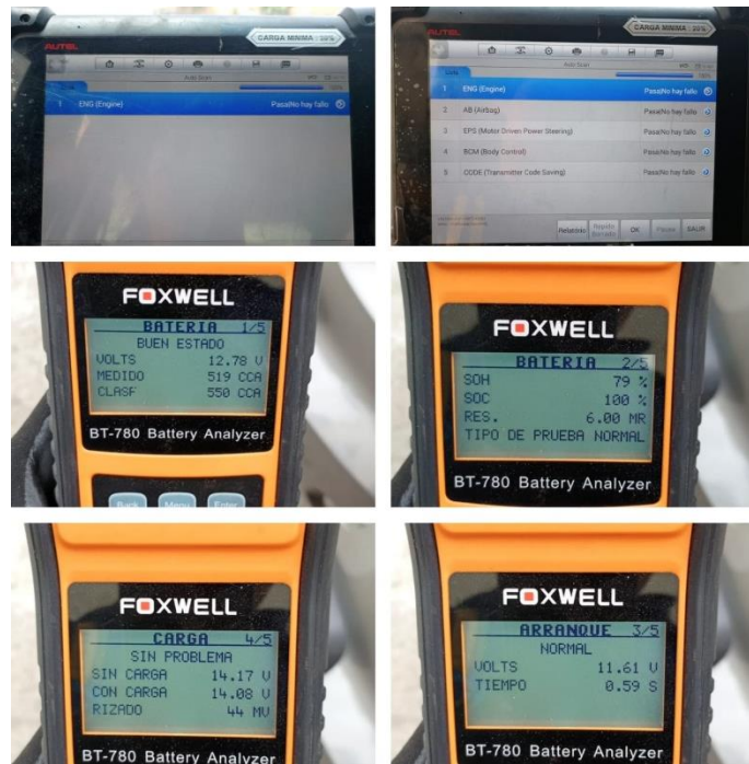
Figura 7.29: Revisión de los vehículos con Scanner y Analizador de batería
