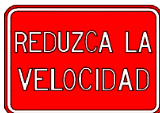
Figura 10. Señal de reduzca la velocidad (R4-4)
