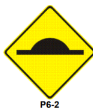
Figura 17. Señal de resalto/reductor de velocidad (P6-2)
