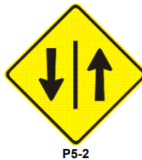
Figura 16. Señal de dos sentidos de circulación (P5-2)
