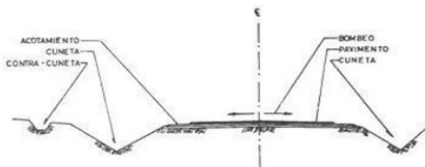
Figura 26. Representación de cunetas en la vía.
