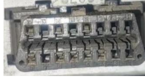
Figura 2- 19 Pines de salida OBD2
