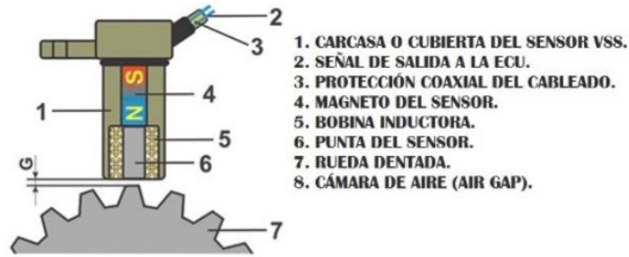
Sensor de velocidad del vehículo (VSS) Efecto Hall
