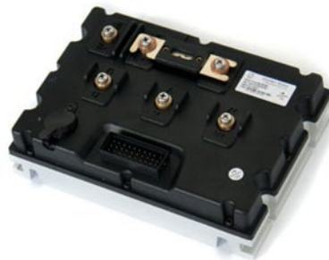
Figura 11: Controlador de Motor 5KW
