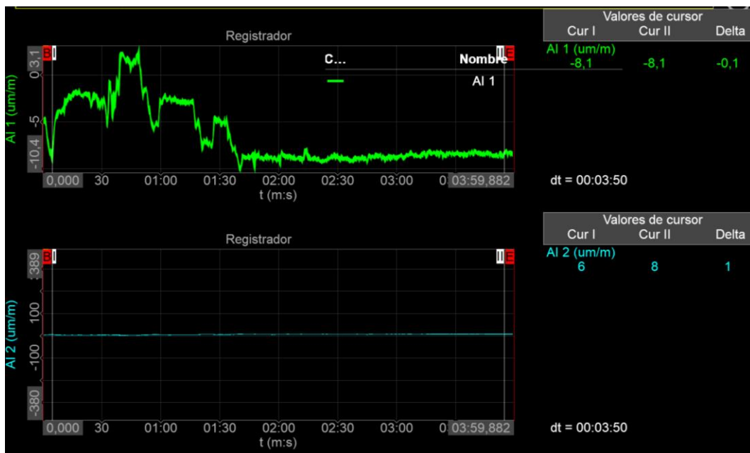
Figura 4.1 Deformación por flexión con carga de 100 Kg
