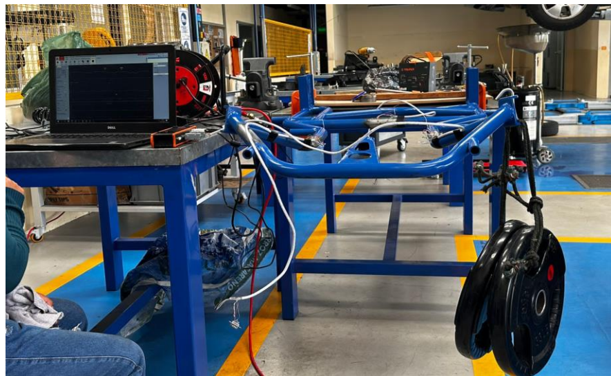
Prueba en posición derecha en voladizo, Fuente: Álvaro Pillajo
