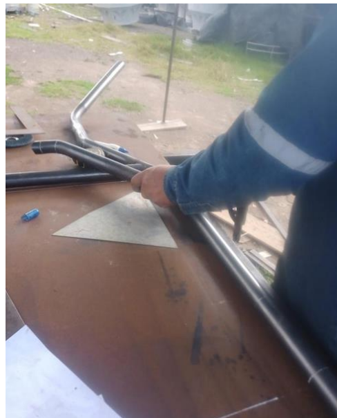
Marcado de medidas y corte de material, Fuente: Álvaro Pillajo.
