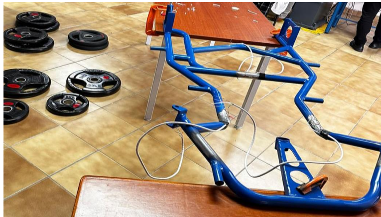
Prueba de deformación a flexión del bastidor, Fuente: Álvaro Pillajo
