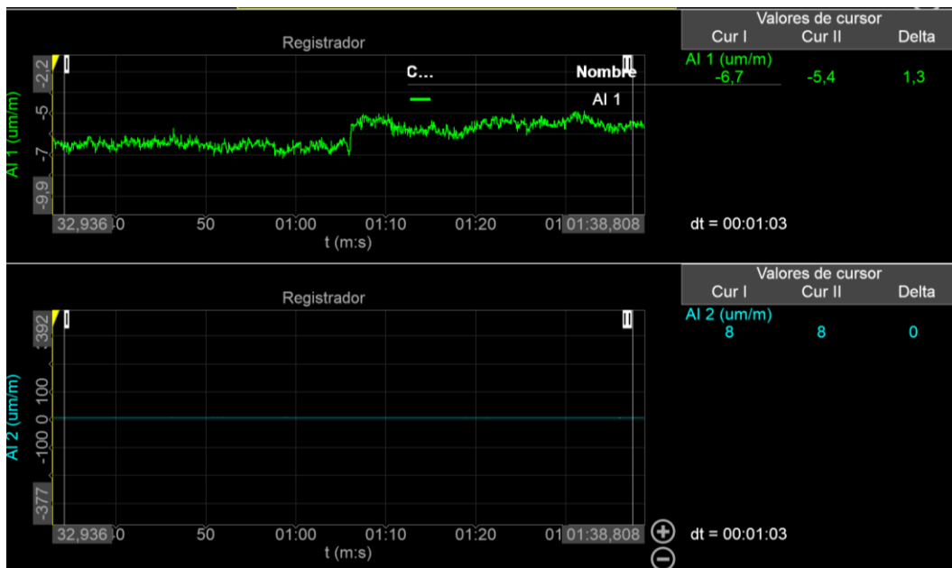
Figura 4.3 Deformación por flexión con carga de 130 Kg.
