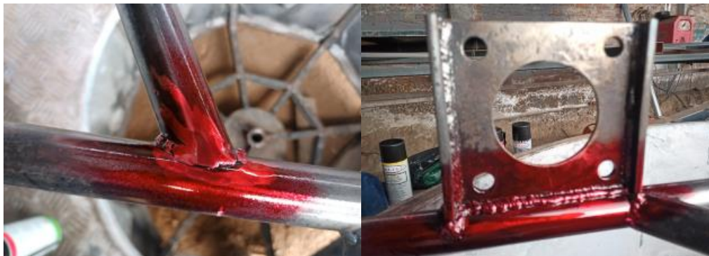
Figura 3.1 Aplicación del líquido penetrante.
