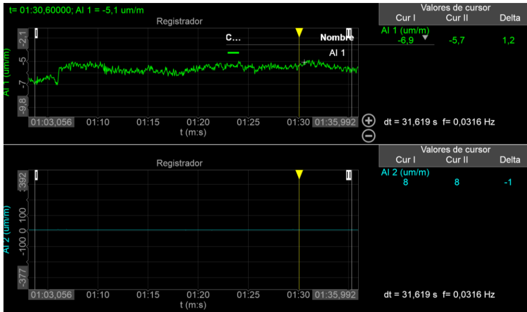
Deformación de la estructura a torsión, Fuente: Álvaro Pillajo
