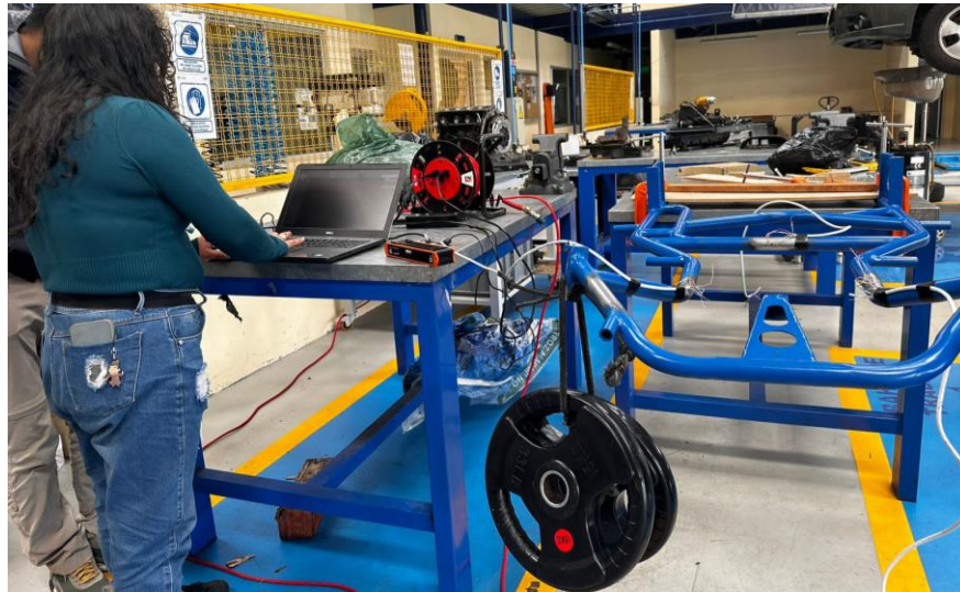
Prueba en posición izquierda en voladizo, Fuente: Álvaro Pillajo
