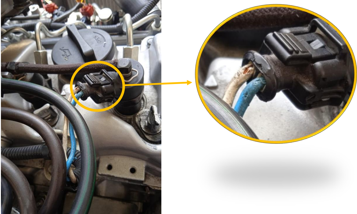
Figura 3.1.1. (2) Inspección Visual del arnés de cables.
