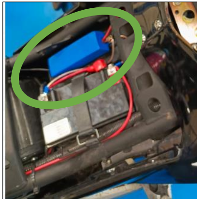
Figura 2.12. Conexión del regulador del voltaje a la batería de la motocicleta.
