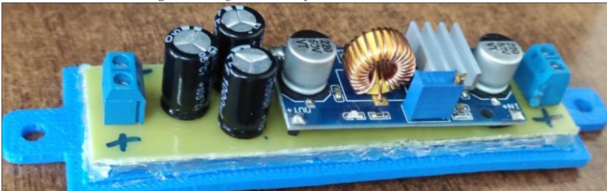
Figura 2.10. Regulador de voltaje de 12V a 5V utilizado en el sistema.
