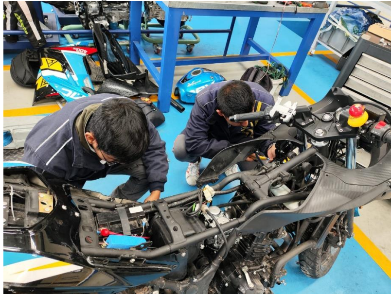
Figura 40. Proceso de conexión del cableado.
