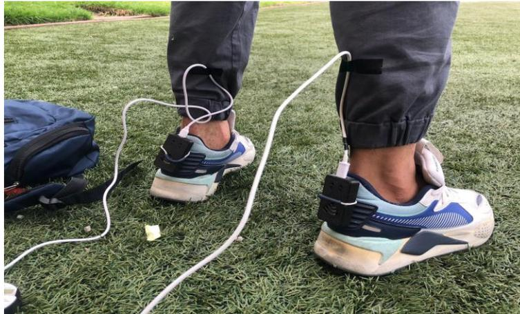
Después de instalar los dispositivos, se trasladó al sujeto a la pista de atletismo de la Universidad Politécnica Salesiana para capturar sus movimientos y analizar la potencia con el prototipo. Como se ilustra en la Figura [Figura 9](#), es importante tener en cuenta que para el análisis posterior de la zancada se debe restar la distancia de 27.5 cm, ya que el sujeto es de talla 43 en el zapato, teniendo en cuenta que la zancada se mide desde la punta hasta el talón.
