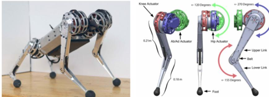
**Nota:** Robot Mini Cheetah y diseño de una pata (Katz y cols., 2019).
