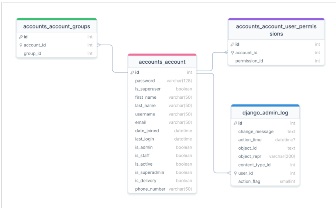
Figura 7: Esquema conceptual de la base de datos del microservicio de cuentas
