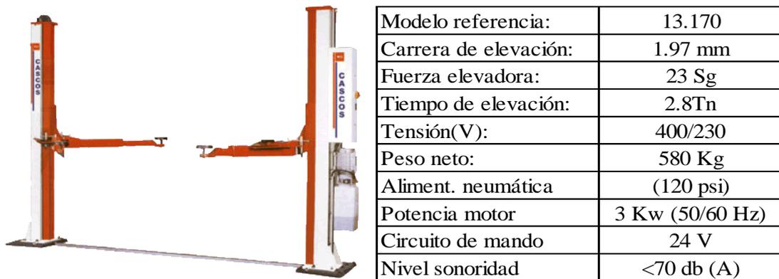
Figura 3.4. Elevador electrohidráulico 2 columnas.<sup>55</sup>
