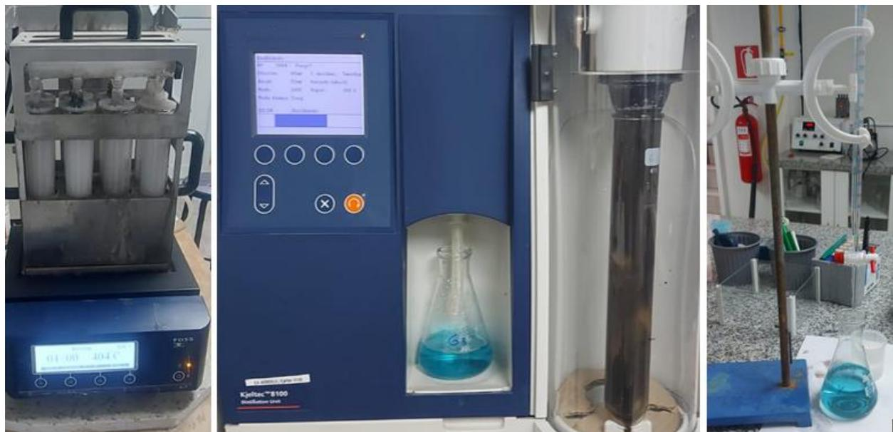
Anexo 16 determinación de la proteína y nitrógeno mediante un proceso de destilación de gases, química y titulación
