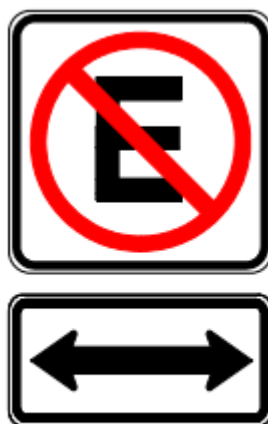
Ilustración 26. Señalización no estacionarse ni a la derecha ni a la izquierda (R5-1c)
