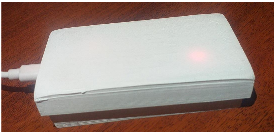
Figura 25: Circuito totalmente protegido por la caja en 3D
