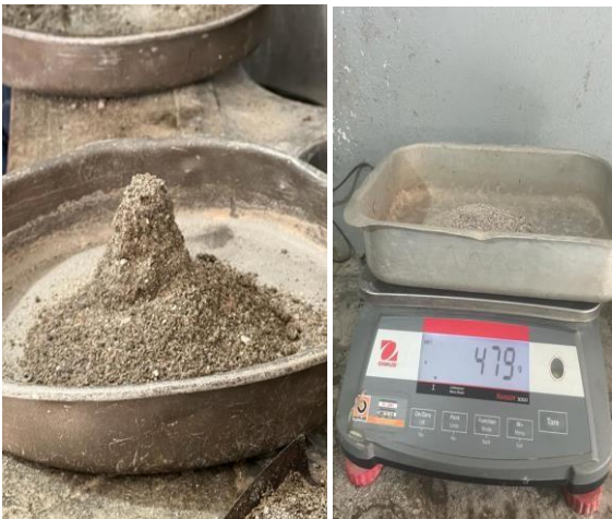
Foto15. Contenido de humedad del árido fino
