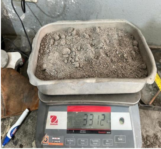
Foto11. Densidad real del árido grueso
