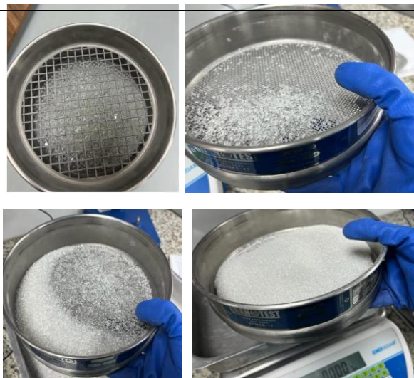
Foto 19. Granulometría del material de cristal molido en base a la norma NTE INEN 696 del árido fino
