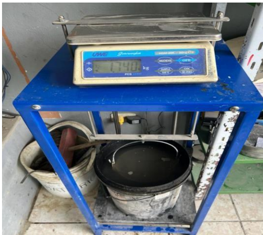
Foto11. Densidad real del árido grueso
