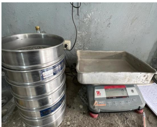
Foto 7. Granulometría para árido fino (Tamices)
