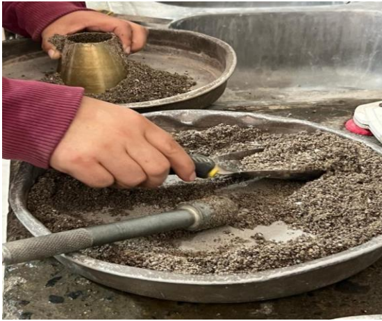
Foto 13. Condición Saturada Superficialmente Seca del árido fino para hallar la densidad
