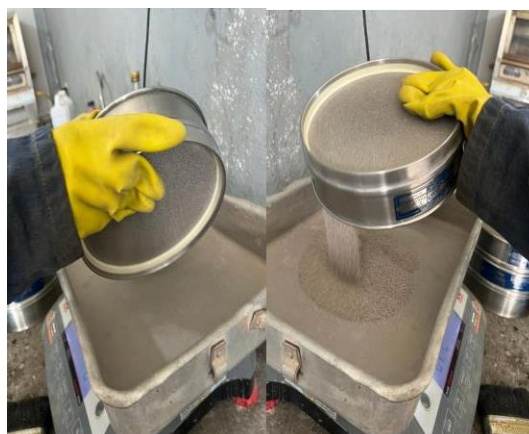
Foto 8. Ensayo de granulometría del árido fino
