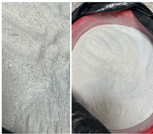
Foto 18. Obtención del material de vidrio molido
