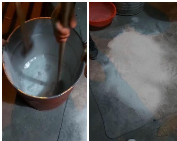
Foto 17. Trituración manual de las botellas de vidrio
