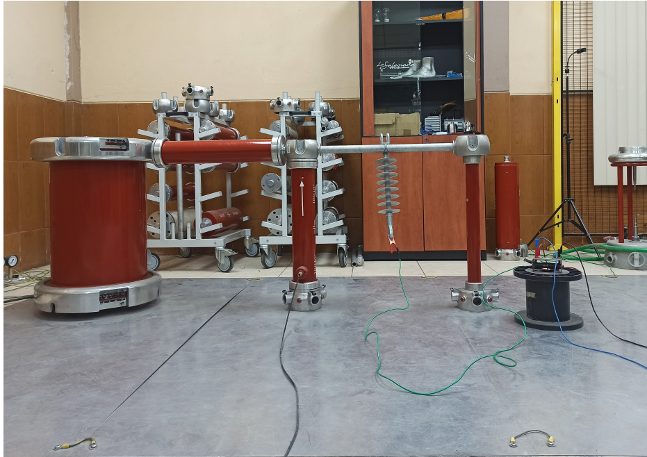
Figura 22: Circuito experimental desarrollado en el Laboratorio de Alta Tensión de la UPS para un aislante polímero ASUS-27.
