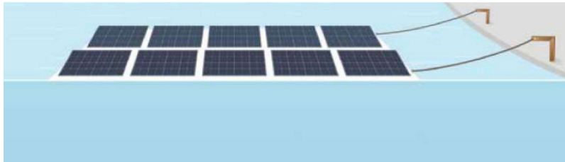
Figura 1.16: Anclaje a la orilla [7].
