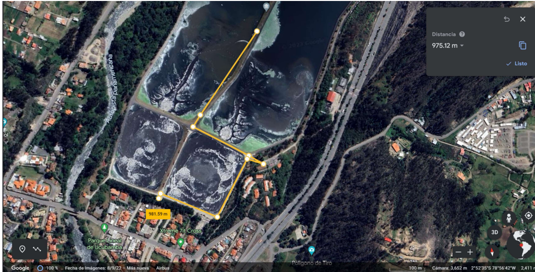
Figura 3.12: Distancia entre los inversores y los medidores[12].
