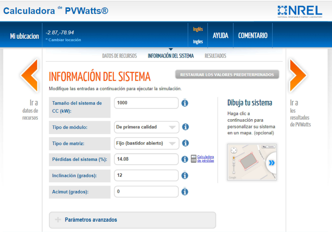
Figura 2.14: Ingreso de datos con 12 grados de inclinación [16].
