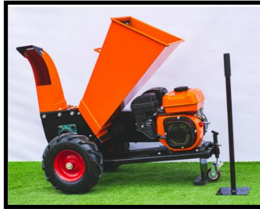
Figura 3 Picadora de raquis de banano.
