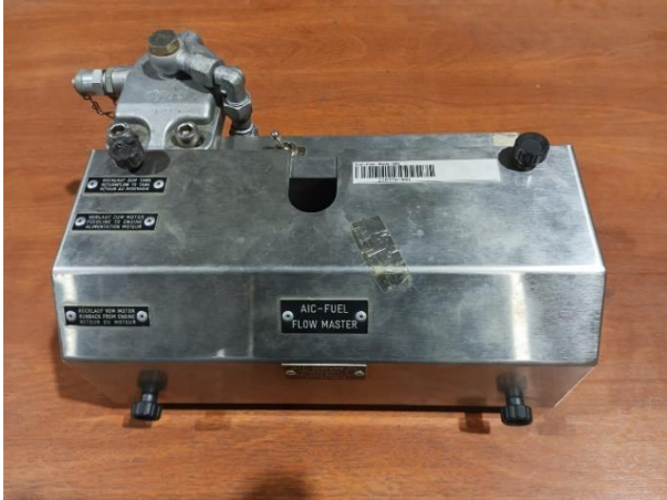
Ilustración 23. AIC 5008 master de flujo de combustible.
