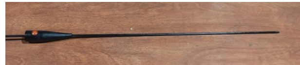
Ilustración 25. Sonda para medir la temperatura del aceite del motor.
