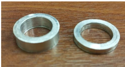
Ilustración 22. Alzas o arandelas de distintas medidas utilizadas (3mm y 6mm) en las bujías.
