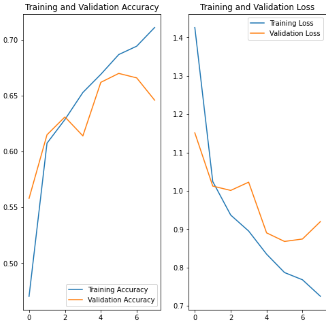
Figura 67. Gráfico correspondiente a la precisión en el entrenamiento y la validación (izquierda). Gráfico correspondiente a la pérdida en el entrenamiento y la validación (derecha). Implementando técnicas de mejoramiento en la red como es data Augmentation y Dropout. [Autor]
