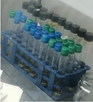
**Anexo 8.** Tubos de ensayo con 9ml de agua peptonada tamponada estéril
