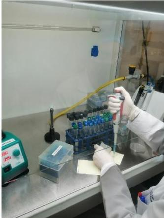
**Anexo 16.** Colocación de 1ml de muestra diluida de manera perpendicular en la lámina de Petrifilm 3M membretada
