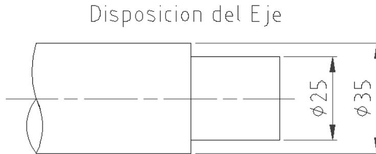
Figura 3. 17. Diámetro del Eje y su gradiente.
