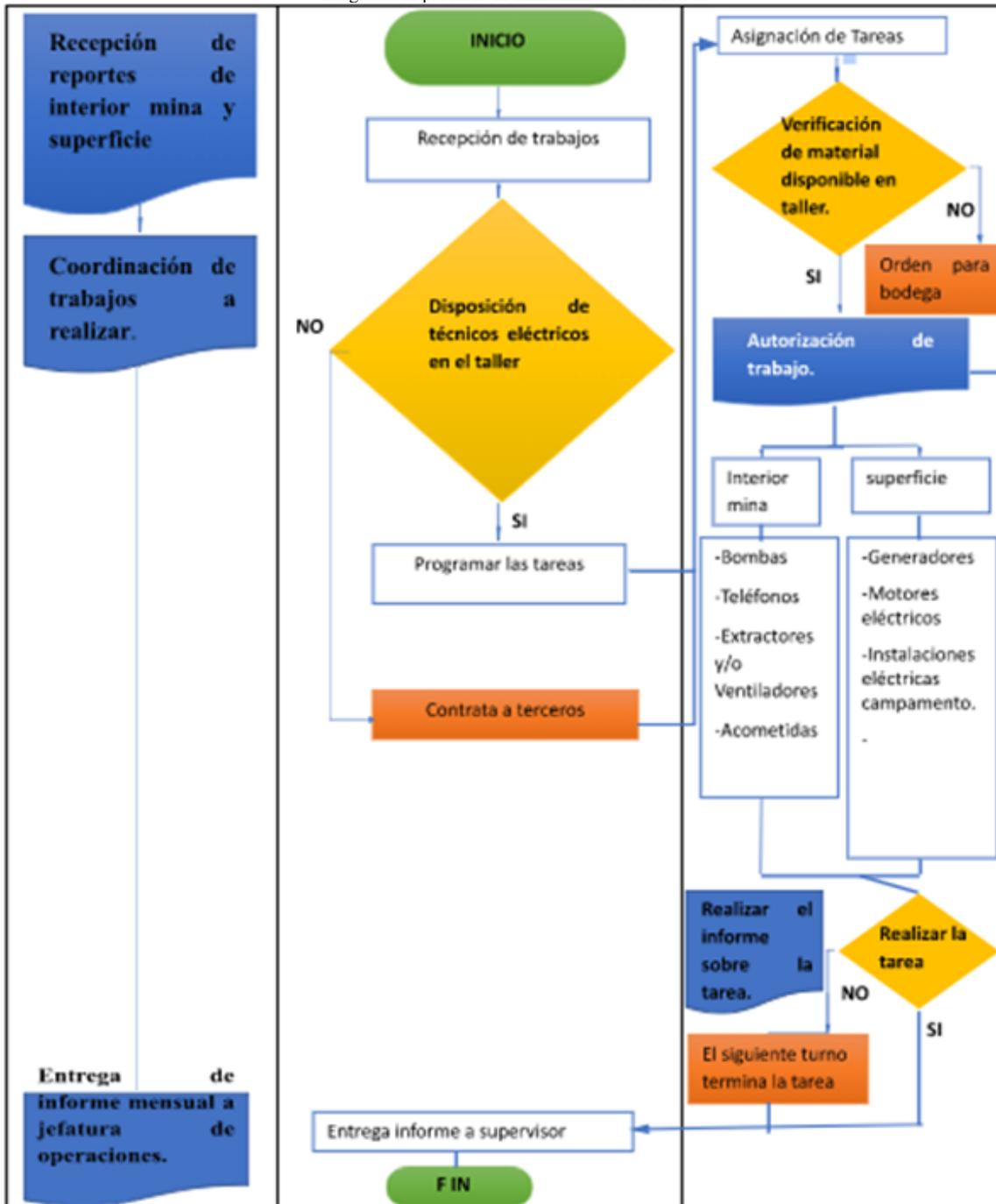
Nota: Diagrama de procesos de mantenimiento correctivo de los motores eléctricos. Fuente: Autor
