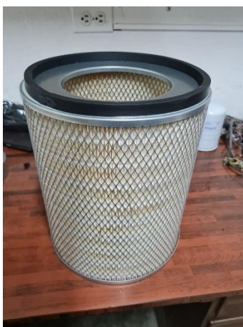
Figura 10 Filtro de Aire.
