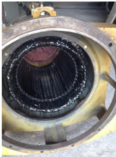
Figura 6 Estator AC 250kW.
