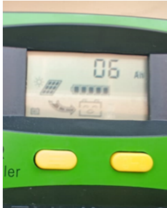
Figura 2.34: Corriente suministrada por el panel solar en condiciones de baja radiación solar. (Fuente: Autores)
