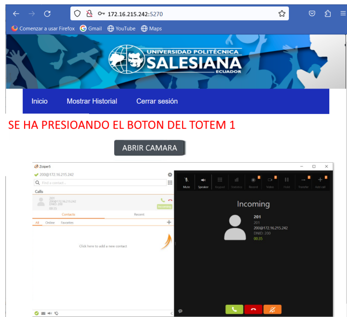
Figura 3.8: Mensaje producido al momento de presionar el botón de pánico. (Fuente: Autores)
