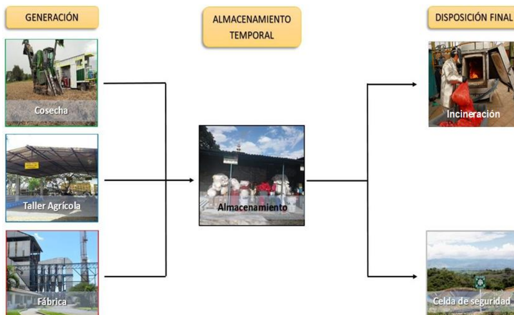
Figura 4 Disposición final de los residuos peligrosos
