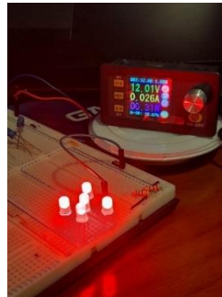
Figura 12: Mediciones de LED rojo protoboard
