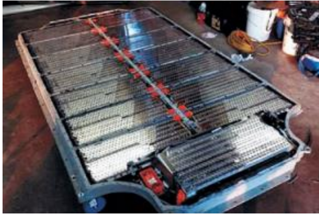
Figura 6. Pack de baterías. Fuente: [9]
