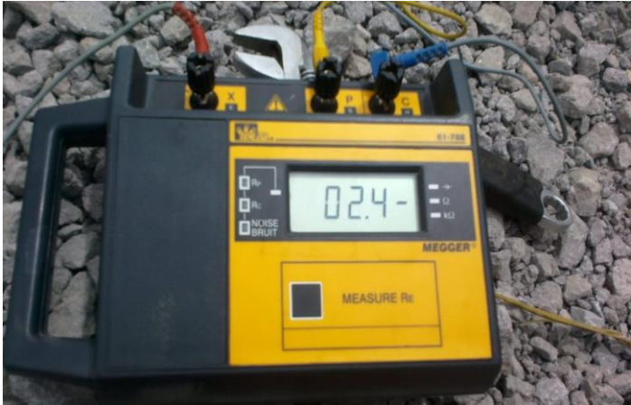
Figura 54. Telurómetro Megger TS-768. Fuente: Autor.
