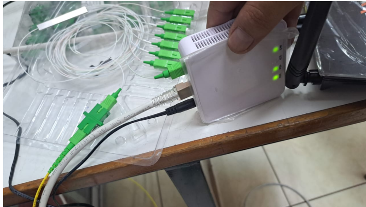
Figura 4.9: Conexión de un splitter en la ONU
