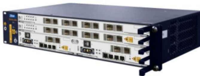
Figura 1.4: OLT ZTE ZXAN 10 C320. Fuente: [6]
