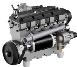
Figura 2 Vista general de MCI L4 [7]
