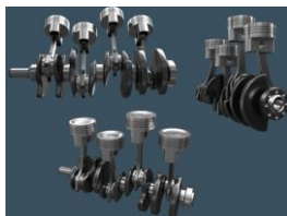
Figura 4 Pistones y Cigüeñal de MCI L4 [7]
