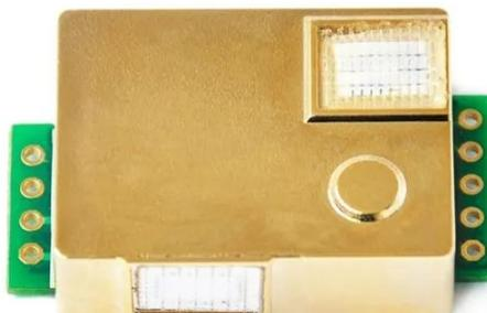
Figura 2.4: Sensor de gas MHZ-19B. [Fuente: El Autor.]
