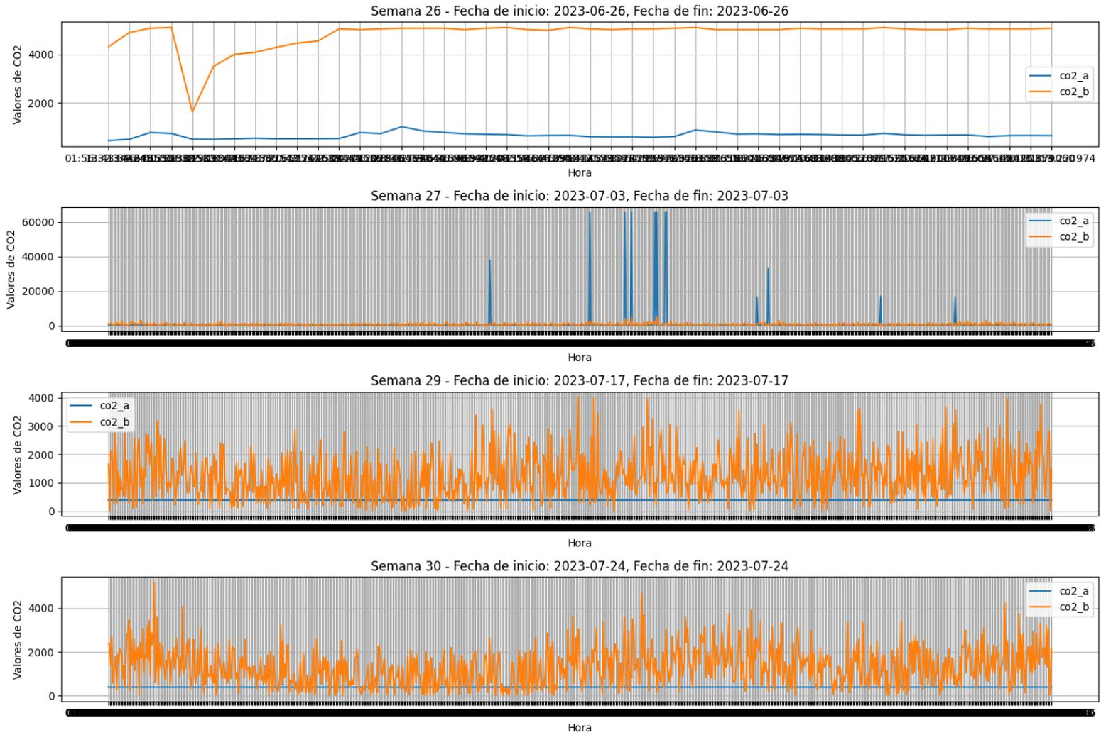
Figura 3.15: Comparación de sensores.[Fuente: El Autor.]
