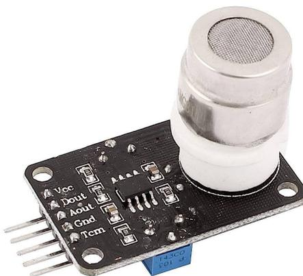
Figura 2.3: Sensor de gas MG811. [Fuente: El Autor.]
