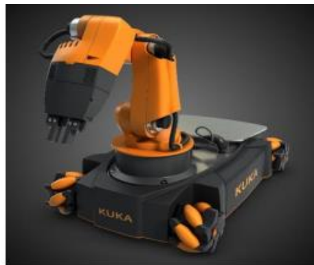
FIGURA 4 Robot manipulador KUKA youbot (Mirelez & Delgado)
