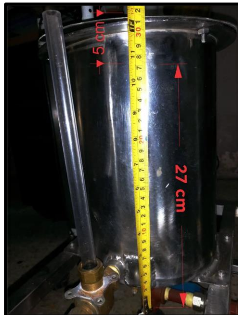
Figura 67. Medición del tanque vacío
