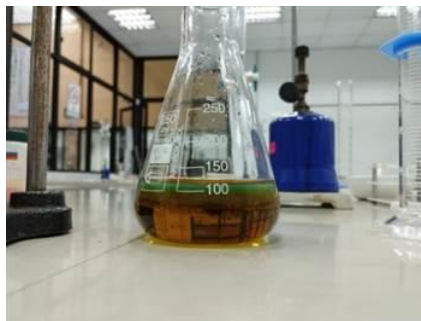
Ilustración 13. Proceso de titulación para C.O.
