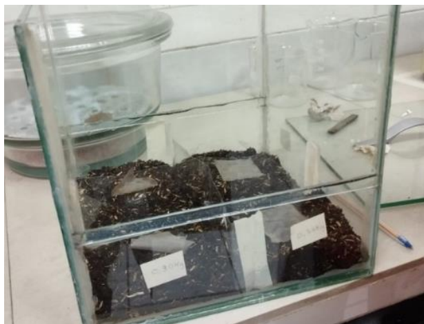
Ilustración 2. Montaje de las muestras en el desecador.
