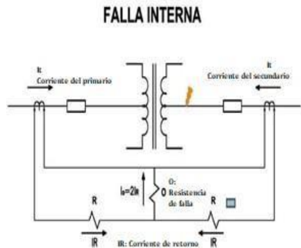
Gráfico N° 2 Falla Interna del Transformador
