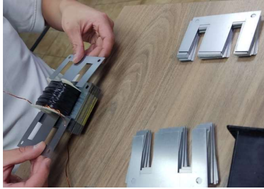
Figura 37. Ensamble Transformador 120VAC-24VAC
