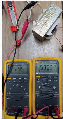
Figura 35. Medición devanado primario y secundario.
