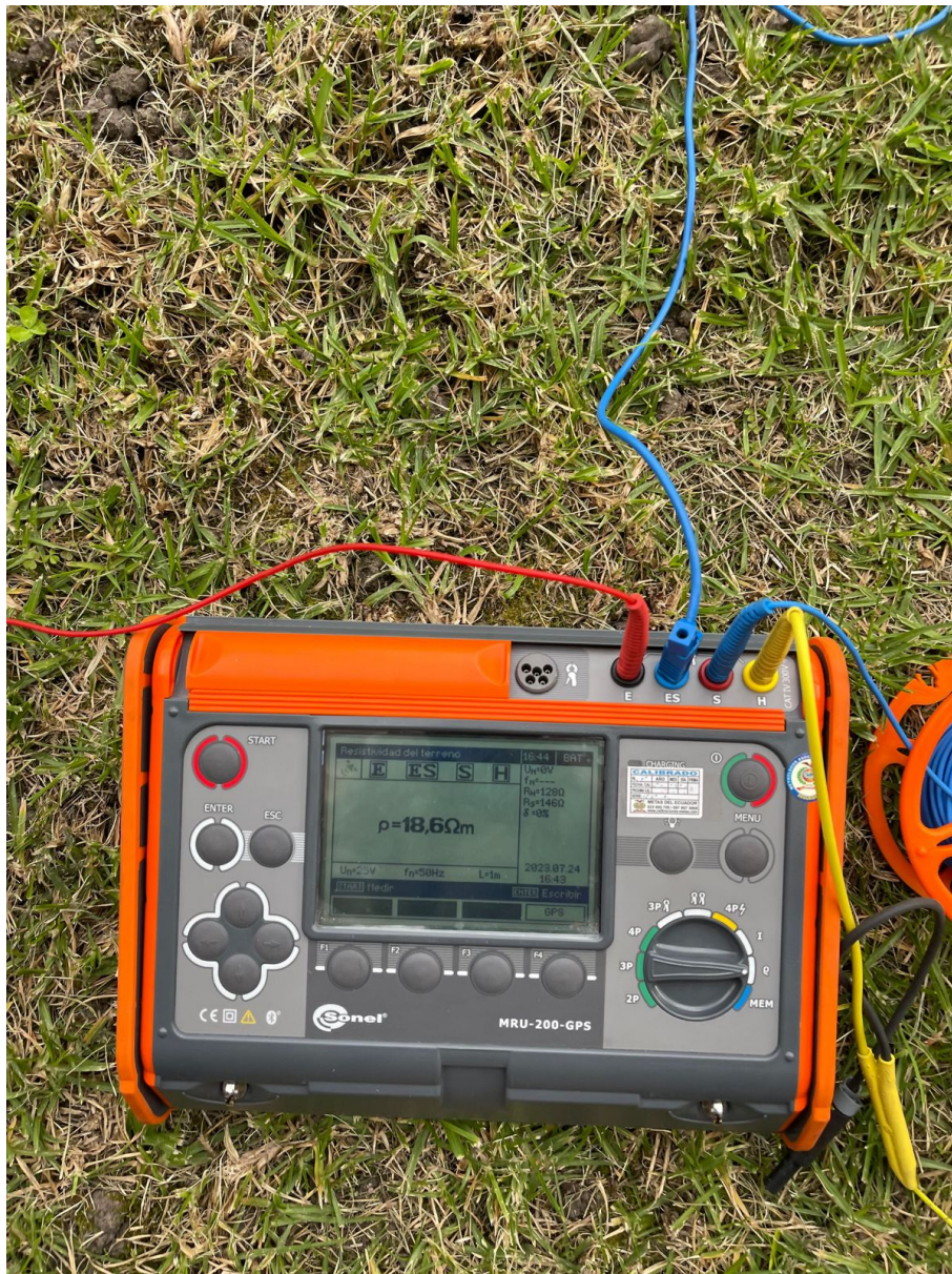
Figura B.1: Medición de resistividad del suelo alrededor del laboratorio de alta tensión, Terreno 1
