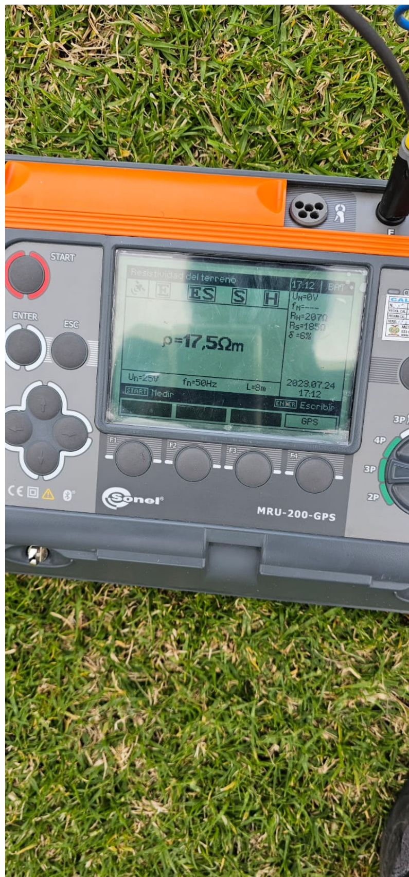
Figura B.4: Medición de resistividad del suelo frente al edificio Juan Botasso, Terreno 5
