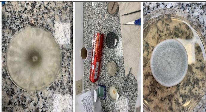
Ensayo de biodegradación con *Penicillium*, *Fusarium* y *Aspergillus*
