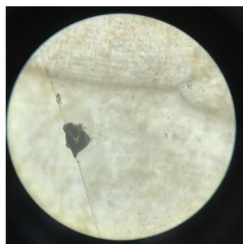
Cambios en la estructura física del plástico a base de tereftalato de polietileno
