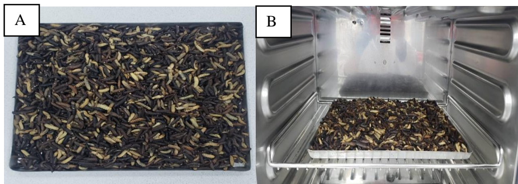
Figura 11: Secado por convección forzada. Extensión de las larvas en un recipiente amplio (A). calentamiento y secado de las larvas en estufa (B). Fuente propia: Jorge Jara, Christian Moran (2023).
