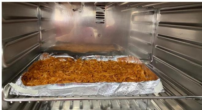
*Figura 16. Secado del material vegetal en estufa.*
