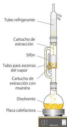
*Figura 4: Equipo de extracción Soxhlet*
