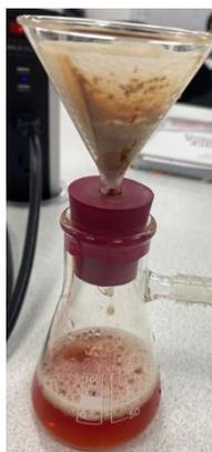
*Figura 18. Filtración de extractos.*
