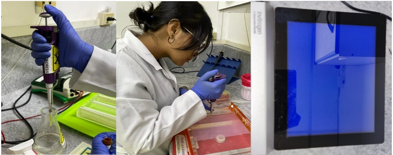
Anexo 10. Electroforesis en gel de agarosa al 1,5% el proceso fue realizado en la cámara de electroforesis horizontal, y sus resultados fueron leídos en el Invitrogen™ Transiluminador de luz azul/blanca de LED doble.
