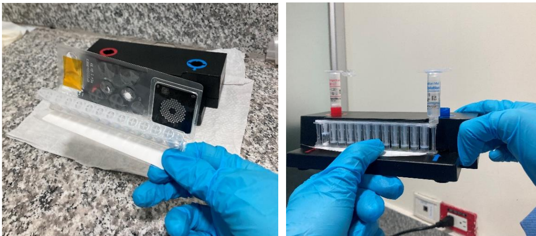
Placa de reacción y cartucho empleado en el sistema POCT.
