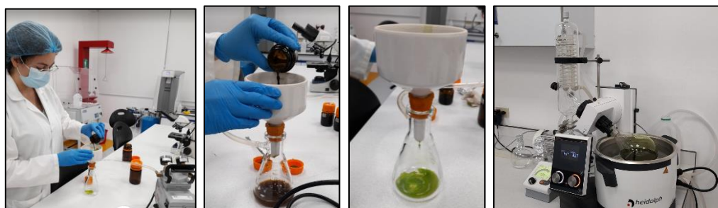
Gráficos 41 a 44: Filtrado al vacío de los extractos obtenidos y proceso de eliminación de solvente del extracto etanólico con rotavapor.
