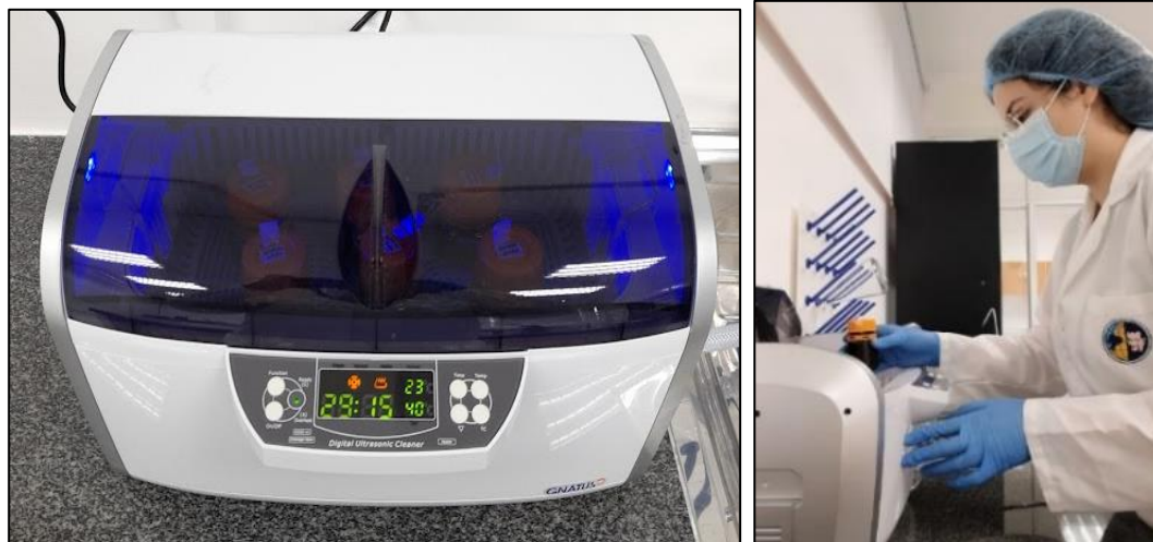
Gráficos 39 y 40: Proceso de obtención de extractos mediante la metodología de extracción por ultrasonido.
