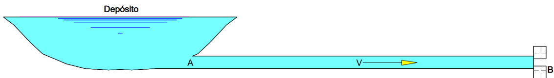
Figura 1. Eventos causados por el golpe de ariete
