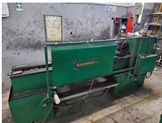
Figura 11. Torno paralelo con bancada de 3 metros de largo Elaboración propia
