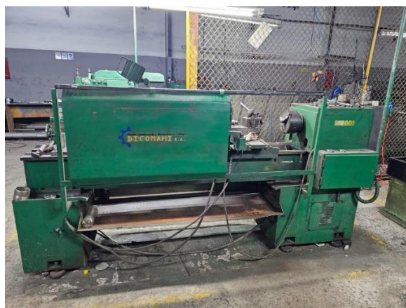
Figura 10. Torno paralelo con bancada de 2.5 metros de largo Elaboración propia
