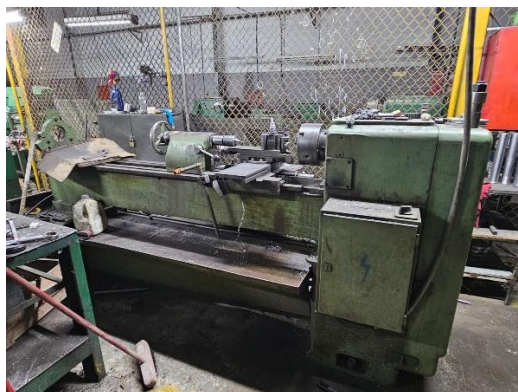
Figura 9. Torno paralelo con bancada de 2 metros de largo Elaboración propia
