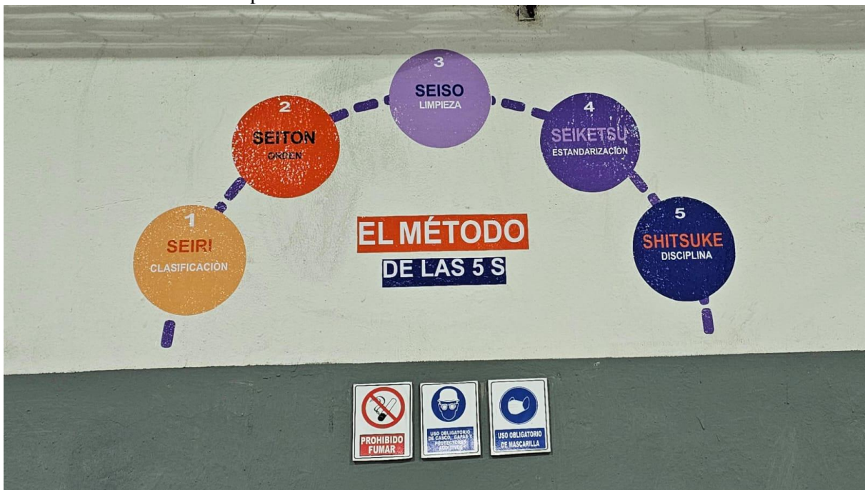
Figura 53. Señalización de las 5S en las paredes de áreas intervenidas
