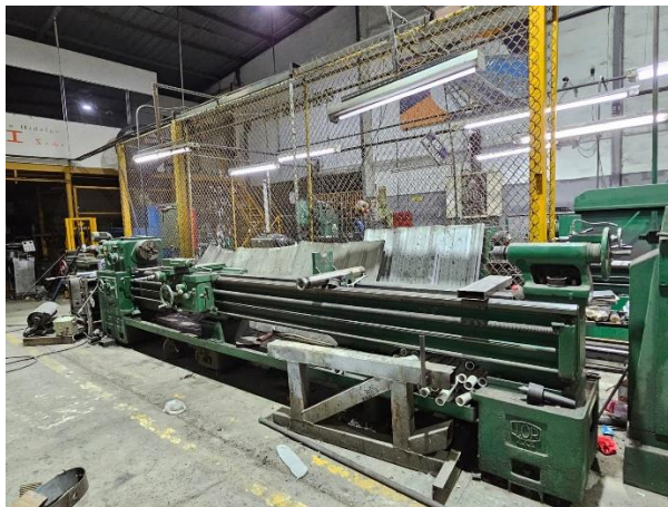
Figura 13. Torno paralelo con bancada de 6 metros de largo Elaboración propia
