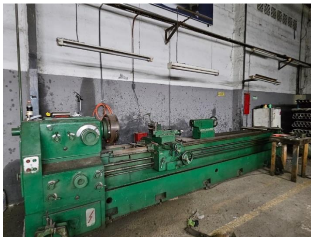
Figura 12. Torno paralelo con bancada de 5 metros de largo Elaboración propia
