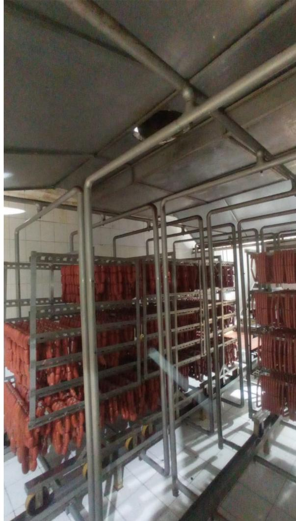
**Nota:** En la figura se puede observar el sistema actual de nebulización que tiene la finalidad de reducir la temperatura de salida de horno que aproximadamente es de 70°C a un temperatura de 14°C previo a pasar al cuarto frío donde se almacenará para su despacho a los centros de distribución.
