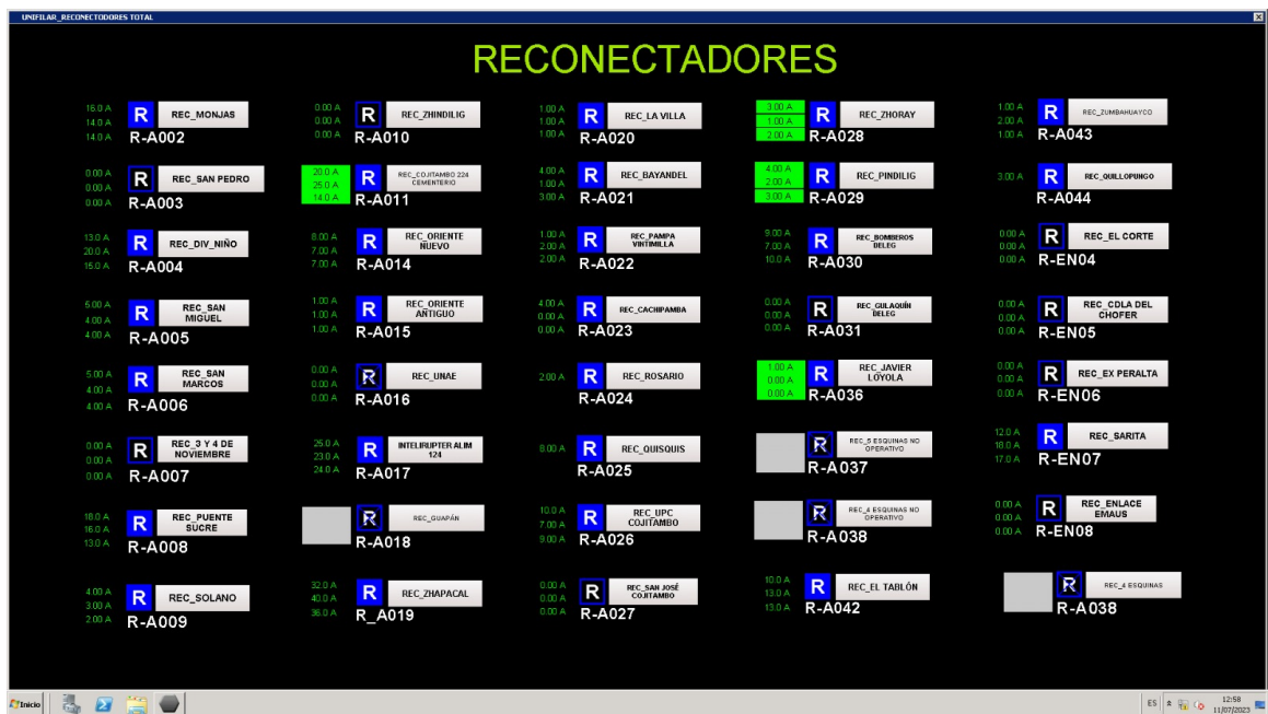
Figura 8. Visualización de reconectores en el sistema SCADA del centro de control
