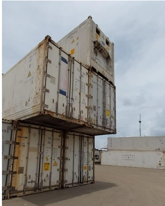
Anexo 3. Apilamiento de contenedores de forma insegura
