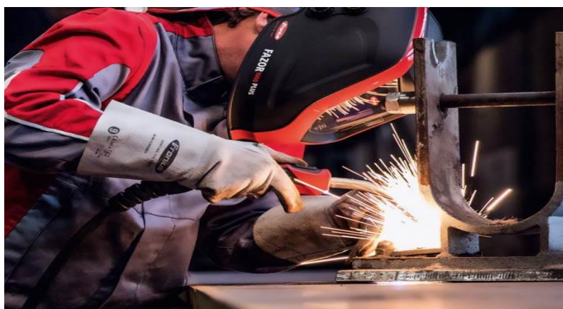
Figura 6 Soldadura por arco metálico y gas
