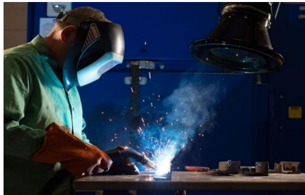
Figura 14 Ventilación por dilución
