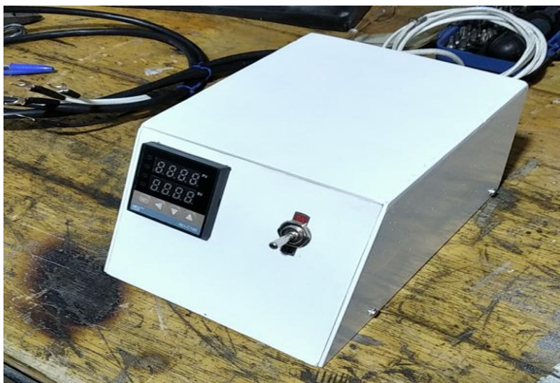
Figura 12. Controlador de temperatura
