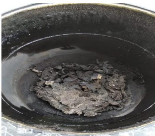
Figura 21. Residuos carbonizados después del proceso de pirolisis
