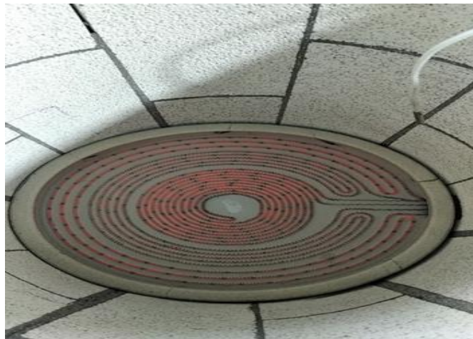
Figura 13. Recámara térmica-resistencia vitrocerámica
